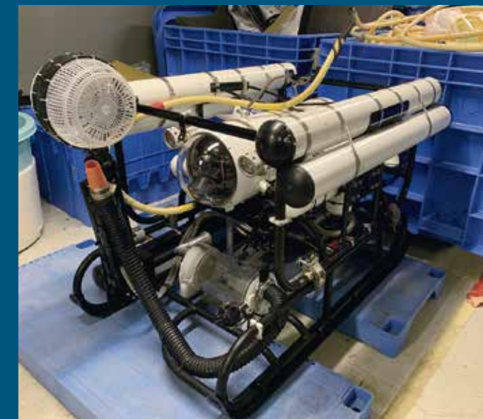
▲Fig.4 ロボットアームとスラップガン(吸引装置)を搭載したROV Fig. 4 ROV equipped with robot arm and slurp gun (suction device)
