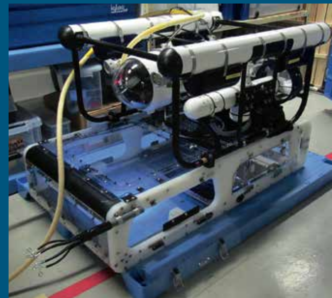
▲Fig.1 箱型採集装置を搭載したROV Fig. 1 ROV equipped with a box-shaped collection device
